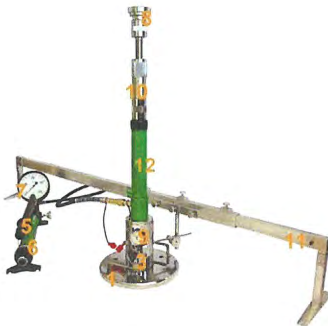
Rys. 1.2 Aparatura VSS z jednopunktowym pomiarem przemieszczenia płyty
